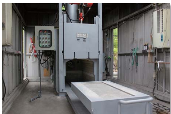
台車：淵部分の高さと幅を仕様変更したモデル。 (DEP-840Y-07)
