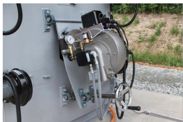
角度可変型バーナー：的確な火炎の照射角度を容易に調整可能。 ブロー：4つのブローで燃焼空気と冷却空気の安定供給
